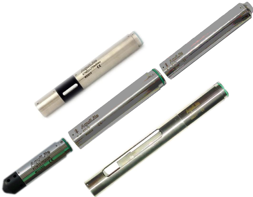
Das einmalige Modulare AquiTronic Sonden- System ermöglicht die Anpassung des Messsystems an verschiedenste Messanforderungen und ist daher vor allem für Pumpversuche geeignet. Eine Modulare Sonde ist jederzeit zu verändern und nachzurüsten, die entsprechenden Module werden dazu einfach zusammengesteckt. Die Verbindungen sind mit O-Ringen abgedichtet und absolut wasserdicht. Alle Module können auch gemietet werden.
